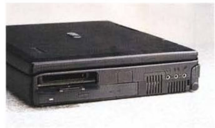
Il lettore di CD-ROM, le due slot PCMCIA e le tre prese jack per l'audio.
